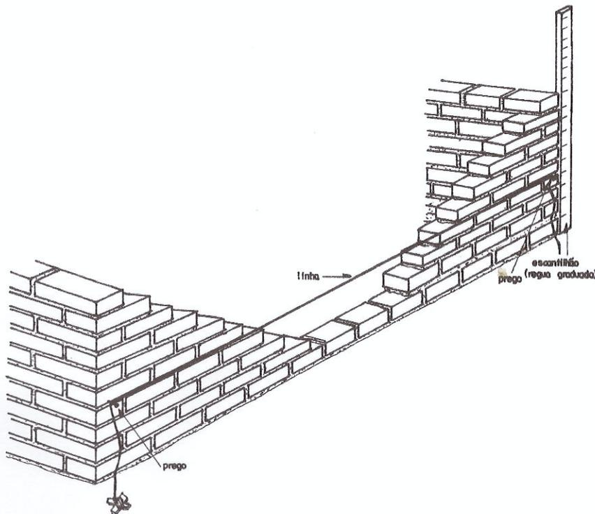
Figura 4 - Detalhe do nivelamento da elevação da alvenaria.
