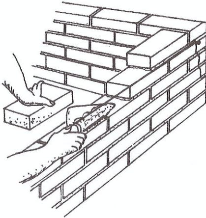
**Figura 6 - Colocação da argamassa de assentamento**
