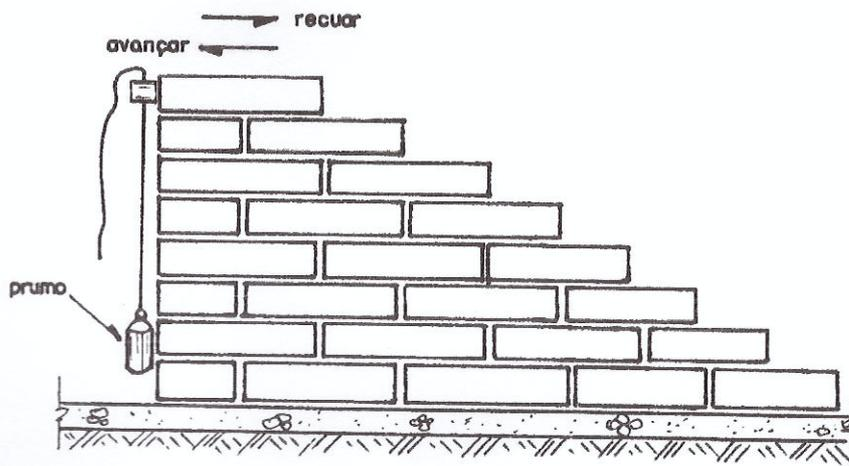
Figura 5 - Detalhe do prumo das alvenarias.
